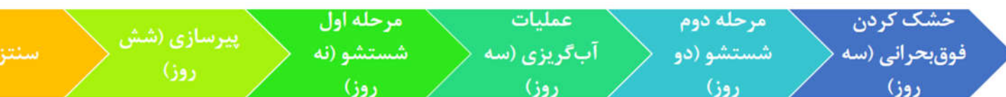
شکل 2- شمایی از مراحل سنتز آئروژل سیلیکایی آب‌گریز.
